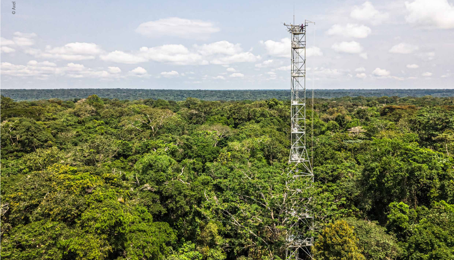
▼ Исследовательская вышка Congoflux, установленная на территории биосферного заповедника Янгамби (ДРК), собирает данные, призванные расширить наши знания о механизмах связывания углерода.
